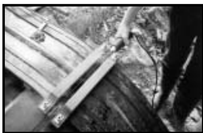
Met de speciale, door Mavotrans ontworpen, lastafel kunnen stompe lassen worden gemaakt
